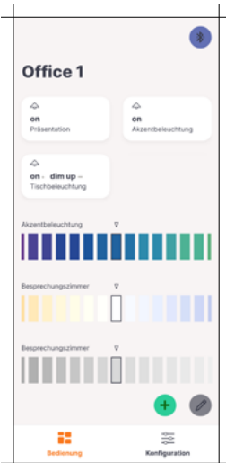
Bedienungsseite zur Lichtsteuerung
